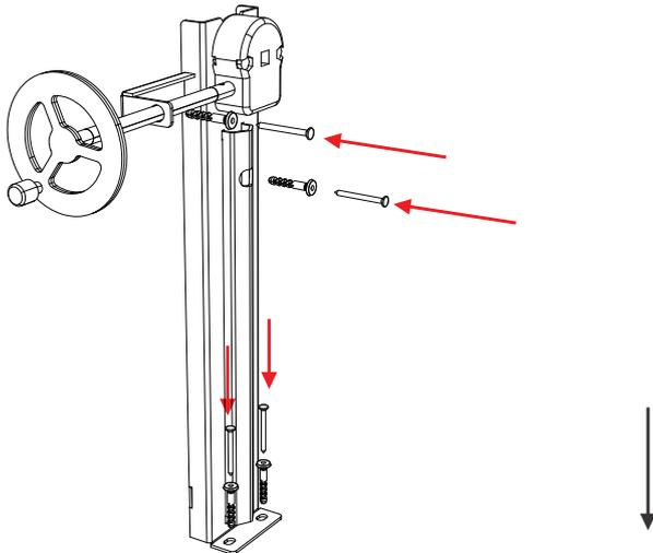
**PASO 2:** MEDIR Y MARCAR EL ENTRECENTRO ENTRE LOS AGUJEROS DE FIJACIÓN DE LAS DOS COLUMNAS PARA REALIZAR LOS AGUJEROS DE FIJACIÓN, LUEGO UTILICE LA PARRILLA PARA CORROBORAR QUE LA DISTANCIA ES LA CORRECTA. POR ULTIMO COLOQUE LOS TARUGOS Y FIJE LA SEGUNDA COLUMNA.
