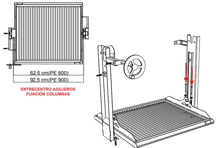
**PASO 3:** INSERTE EL EJE DE ELEVACIÓN EN EL SISTEMA Y AJUSTE EL MISMO ENTRE LAS DOS ARANDELAS Y LA SEGUNDA COLUMNA; DE ESTE MODO EL SISTEMA ESTARÁ INSTALADO CON LAS MEDIDAS CORRESPONDIENTES PARA UN FUNCIONAMIENTO CORRECTO.
