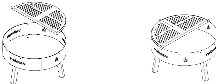
**PASO 3:** Ubicar el soporte para cruz en el borde del Duomo 650, alinear los agujeros del soporte con los del duomo 650 (Fig 1.2), ubicar los tornillos (Fig 1.3) ajustar firmemente, colocar la base de la cruz (1.4), ajustar y por ultimo colocar el asador cruz.
