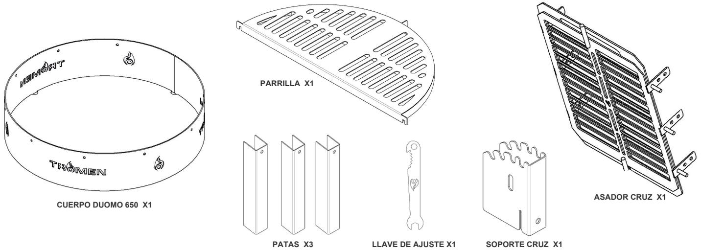
**PASO 1:** Colocar el Duomo 650 boca abajo, ubicar las tres patas en su encastre. Ubicar los tornillos (Fig.1) y ajustar firmemente. Luego dar vuelta para colocar el resto de los accesorios.
